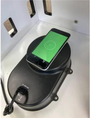
A smartphone is placed on a leveling tool (a circular base with a bubble level) to ensure it is perfectly horizontal. The phone's screen shows a green level indicator. | iPhone の計測アプリで水準器を使って、0度になるように DOB10 の足を調整する。                                                     |
