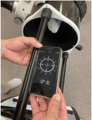
A hand holds a smartphone displaying a compass app. The phone is positioned vertically, aligned with the telescope's axis to determine true north.                     | iPhone のコンパスアプリを使って、軸に沿わせて固定し、真北を向くように DOB10 を回す。<br><br>※注意：事前に、設定→コンパス→真北を使用にチェックする。磁北ではずれてしまう。 |
